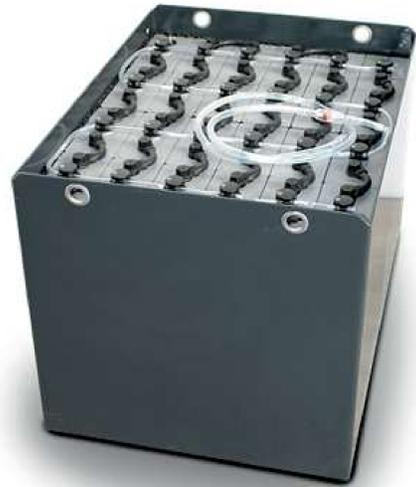
Der **Bleiplatten-Säure-Akku** besteht aus mehreren Zellen, die in Reihe geschaltet werden. Es kommen den Staplern in der Regel Akkus von 24 Volt (12 Zellen), 48 Volt (24 Zellen) oder 80 Volt (40 Zellen) zum Einsatz.
